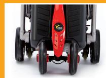
Sistema amortiguación frontal patentado con efecto "4 ruedas separadas"
