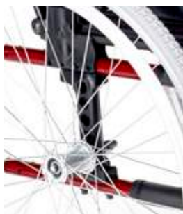
Pletina trasera del eje de aluminio
