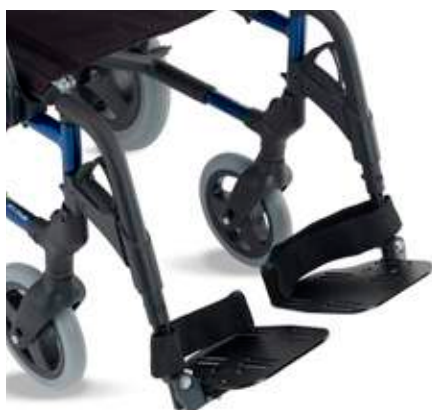
Plataformas de aluminio regulables en ángulo
