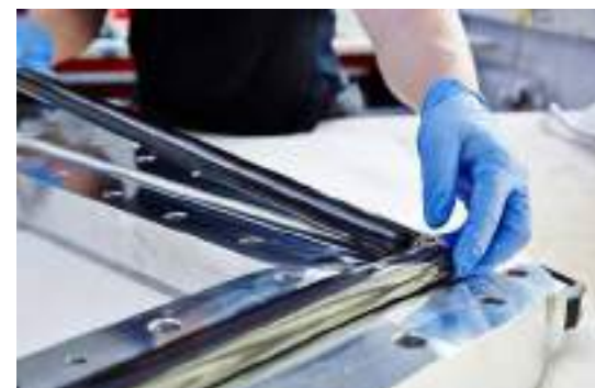
Moldeado e inyección de resina
